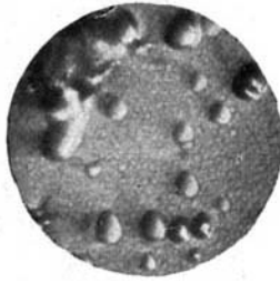
Fig. 8. Dasselbe Ag-Stück. K.F. 2000 Volt. 2 Stunden. „Netzstruktur“ u. ovale Vertiefungen. Vergr.: 300.
