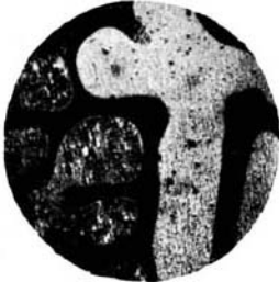
Fig. 16. Cu-Ag-Legierung. Primär ausgeschiedene Cu-Dendrite. Einzelne Dendrite verschieden strukturiert. Vergr.: 80.
