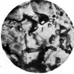
Fig. 4. Cu-Draht, 20 Min. bei 900° rekristallisiert. Krystallogr. orientierte Vertiefungen, „Ätzfiguren“. Vergr. 300.
