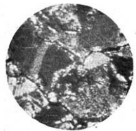
Fig. 12. Dasselbe Ag-Stück. K. F. 2000 Volt. 1 1/2 Stunden. Sehr starke feine Aufrauhung. Vergr.: 80.
