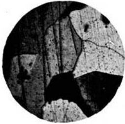
Fig. 19. Ag-Sn - Mischkristalle, 14% Sn. K. F. 1500 Volt. ½ Sde. Kristallite z. T. von dunklem Überzug bedeckt. Vergr.: 80.
