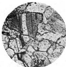
Fig. 11. Ag rekristallisiert. K. F. 2000 Volt. 1/2 Stunde. Schwache Aufrauhung. Vergr.: 80.
