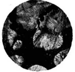
Fig. 15. Ag-Cu-Legierung. Primär ausgeschiedene Ag-Dendrite mit feiner Linienstruktur. Vergr.: 80.
