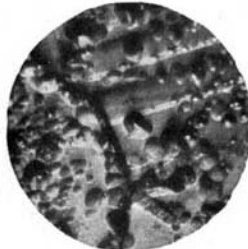
Fig. 5. Cu-Draht, 1 Stde. bei 900° rekristallisiert. Sehr viele runde Vertiefungen. Vergr.: 300.
