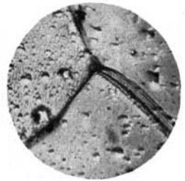
Fig. 9. Ag regulinisch erstarrt. 3 aneinandergrenzende Krystallite mit verschiedener Aufrauhung.
