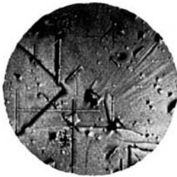
Fig. 22. PbS Spaltfläche, in Ar Oberfläche glatt mit wenigen grösseren Unebenheiten. Vergr.: 80
