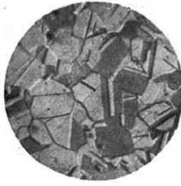
Fig. 2. Gewöhnlicher Cu-Draht. K. F. 1100 Volt. 1 Stde. Vergr.: 300. Krystallite glatt.
